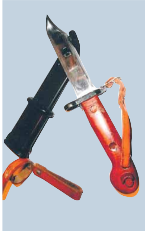
Bagnet nożowy Ak-47 oznaczony 6H3 złożony jako nożyce
